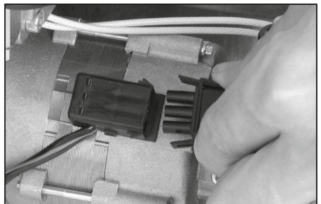
Afbeelding 28 — Stekkeraansluiting voor motor
