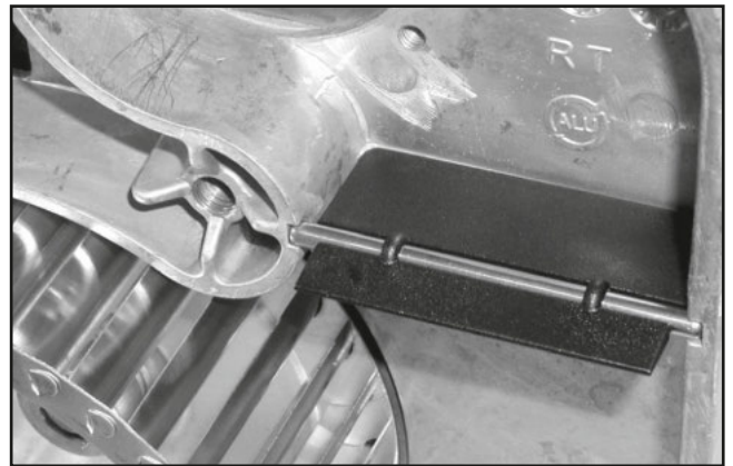
Afbeelding 26 — Positioneren van de luchtklep
