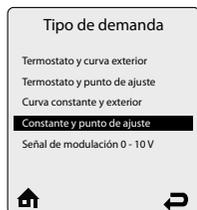
**Constante y punto de ajuste** – La Prestige mantendrá el punto de ajuste y las bombas de circulación de calefacción central estarán constantemente activadas sin una llamada externa desde un interruptor de contacto seco. Las bombas de circulación de calefacción central se desactivarán cuando la temperatura exterior supere el nivel definido por el parámetro de **Apagado Tiempo Cálido**. El punto de ajuste se fijará para las llamadas de calefacción central.
