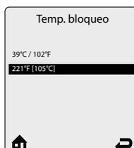
El parámetro **Temp. bloqueo** de la caldera permite comprobar la función Sobrecalentamiento de Termostato a una temperatura reducida. Disminuye temporalmente la temperatura de sobrecalentamiento del aparato hasta 39 °C, lo que permite una comprobación segura de la función.
