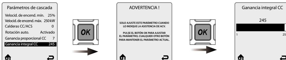
**Ganancia Integral de CC** permite ajustar la respuesta en cascada para una llamada de calefacción central. La Ganancia Integral de CC alcanza su mayor influencia cuando la temperatura del sistema está cerca del punto de ajuste.
