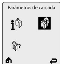
El menú **Parámetros de Cascada** contiene parámetros relacionados con el funcionamiento en cascada. Cada línea contiene un parámetro de cascada seguido de su valor actual. En la pantalla se muestran seis Parámetros de Cascada al mismo tiempo.
