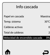
**Velocidad de encendido en cascada** – Muestra la velocidad de encendido actual de todo el sistema de cascada.
