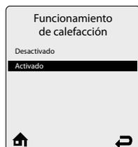
**Funcionamiento de calefacción** – Permite activar o desactivar la función de calefacción central.
