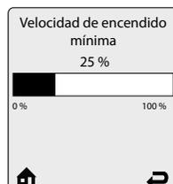
**Velocidad de Encendido Mínima** es la velocidad de encendido mínimo de una sola caldera en el sistema de cascada. La caldera maestra utiliza esta configuración para determinar cuándo las calderas pueden ser activadas y desactivadas.
