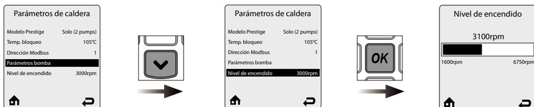
Este parámetro permite modificar la velocidad de arranque del ventilador del aparato.
