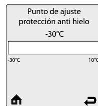
**Punto de ajuste de protección anti hielo** permite definir la temperatura del aire exterior con la que se activa la función anticongelante (sólo disponible si está conectada una sonda de temperatura exterior). Las bombas se activan cuando la temperatura exterior cae por debajo del umbral definido en este menú.
