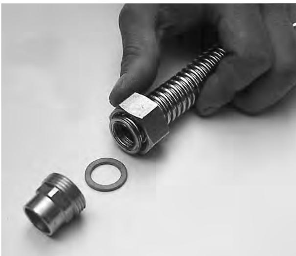
Fig 8 Si le résultat de l'écrasement du bout du flexible vous semble correct, vous pouvez placer le joint et remonter le nipple. serrage de la même façon qu'avec le disque intermédiaire.
