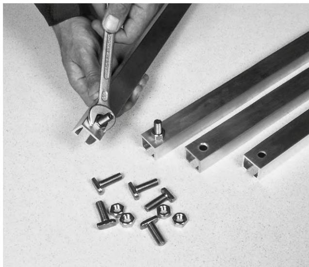
Fig. 11 Préparez les profilés de montage au sol. Insérez d'abord du côté intérieur dans tous les orifices des profilés les vis à tête marteau et serrez les écrous
