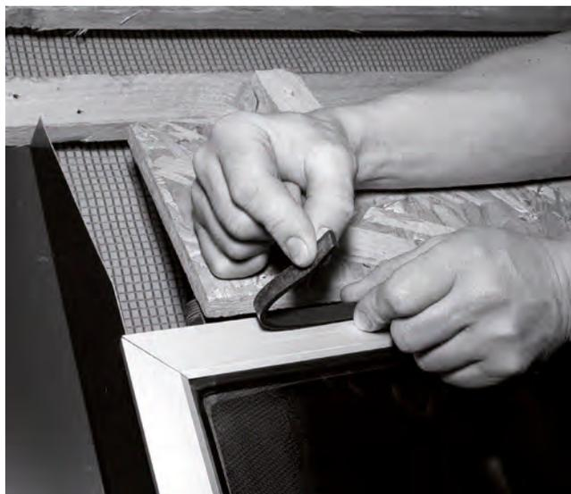
Figure 30 Collez une fine bande de ruban adhésif, en caoutchouc isolant, sur la bordure supérieure du capteur
