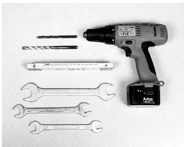
Fig. 9 Outils nécessaires au montage: mètre pliant, perceuse mèche pour métal 8,5 mm ou mèche pour béton 12 mm, clé plate 16, 19, 24, pinces et éventuellement une scie à métaux.
