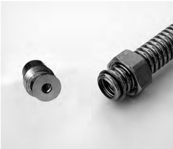
Fig 6 Lorsque cela est fait, placer le disque intermédiaire et le nipple sur le bout de flexible et rapprochez l'écrou presse-étoupe pour visser les deux parties ensemble.
