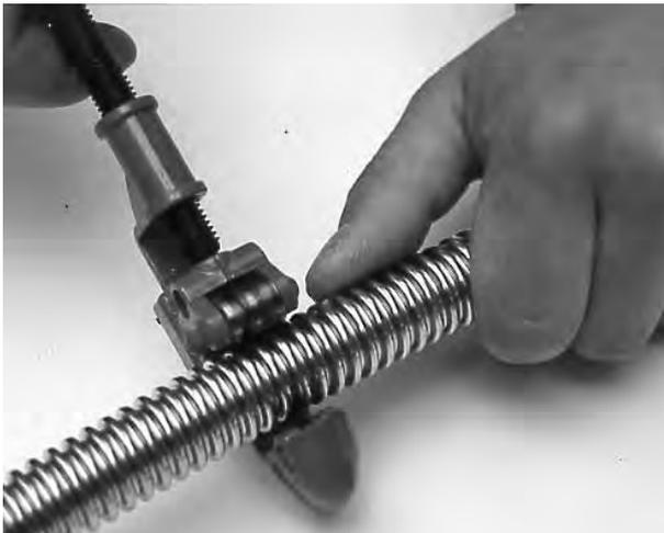
Fig 4 Couper le flexible annelé à la longueur voulue dans une encoche à l'aide d'un coupe-tube ou d'une scie à métaux. Ebarbez ensuite.
