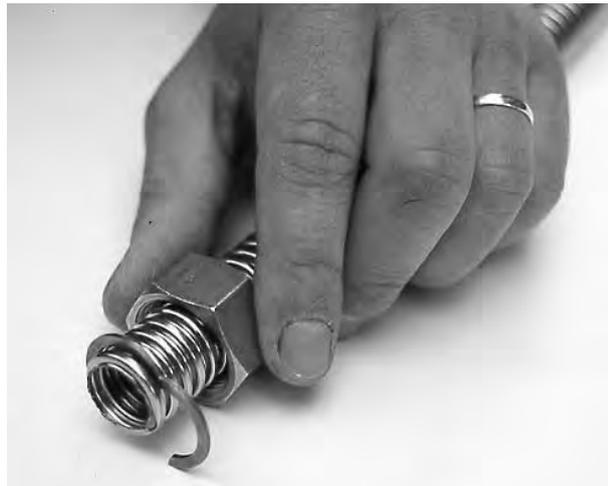
Fig 5 Passez l'écrou presse-étoupe sur le flexible et placez le clip dans la dernière encoche et refermez-le en veillant à ne rien déformer.
