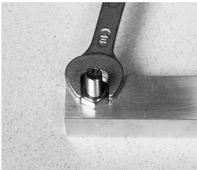
Fig. 12 Lors du serrage, prenez soin que le flanc de l'écrou soit bien ajusté en position perpendiculaire au côté long du profilé. Important pour l'ajustage final du capteur !
