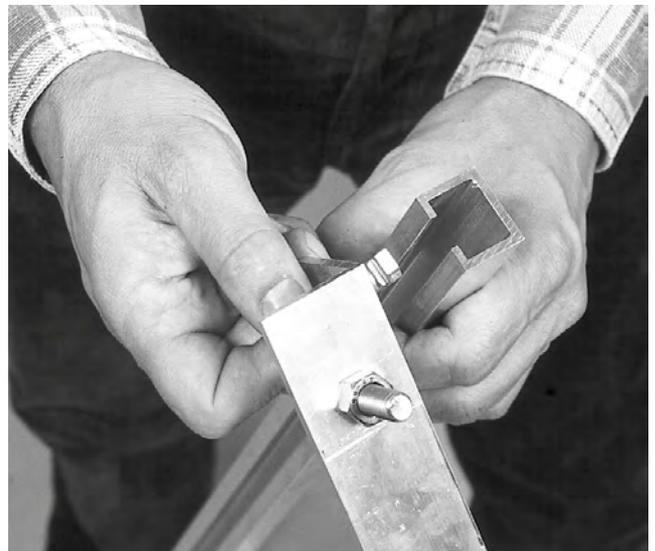
Fig. 14 A partir de ce profilé (pièce 1 Fig. 2,3 ou 4) et du rail de montage, mettez en place la structure triangulaire du châssis. Fixez le rail en fonction de l'inclinaison souhaitée. Prévoyez éventuellement de scier le bout qui dépasse.
