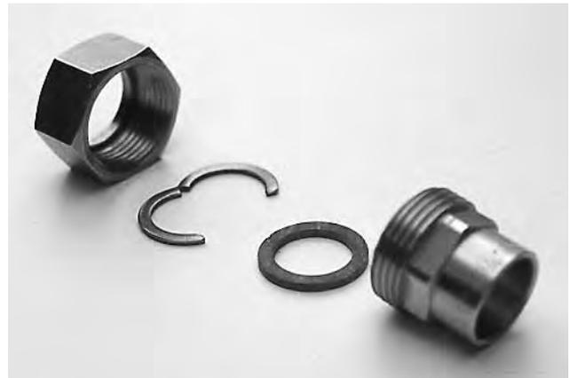
Fig 2 Le raccord rapide destiné à la ligne HeliLine consiste en un écrou presse-étoupe, un clip, un joint et un nipple pour éventuellement passer de 18 à 22 mm pour la soudure à une tuyauterie cuivre.
