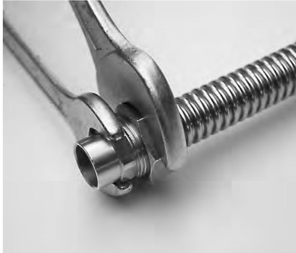
Fig 7 Tenir l'écrou presse-étoupe à l'aide d'une clé et visser le nipple à l'aide d'une autre clé. Lorsque cela est fait, démontez et ôtez le disque intermédiaire.
