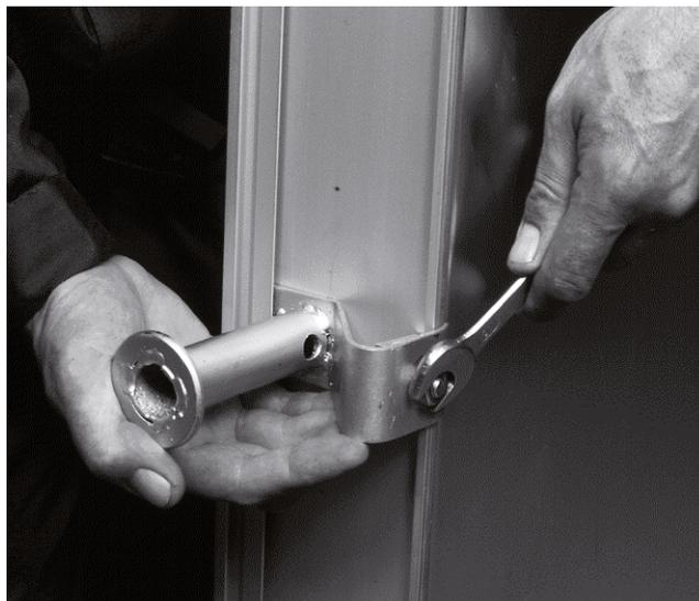
Figure 12 Nous pouvons fournir sur demande des poignées de transport. Elles se vissent sur les deux côtés du capteur. La poignée est fixée du côté de la vitre. Assurez-vous de la solidité.
