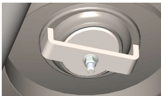
TRAPPE DE VISITE DU RÉSERVOIR ECS
