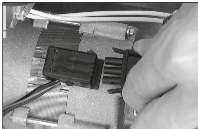
Figure 28 — Prise de raccordement pour le brûleur
