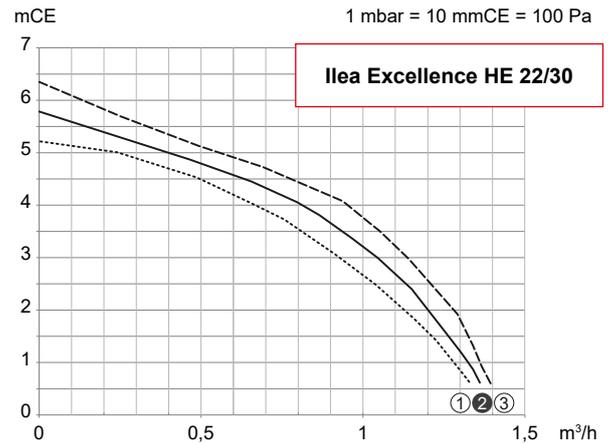
fig. 28 - Verfügbare Drücke und Volumenstromstärken
