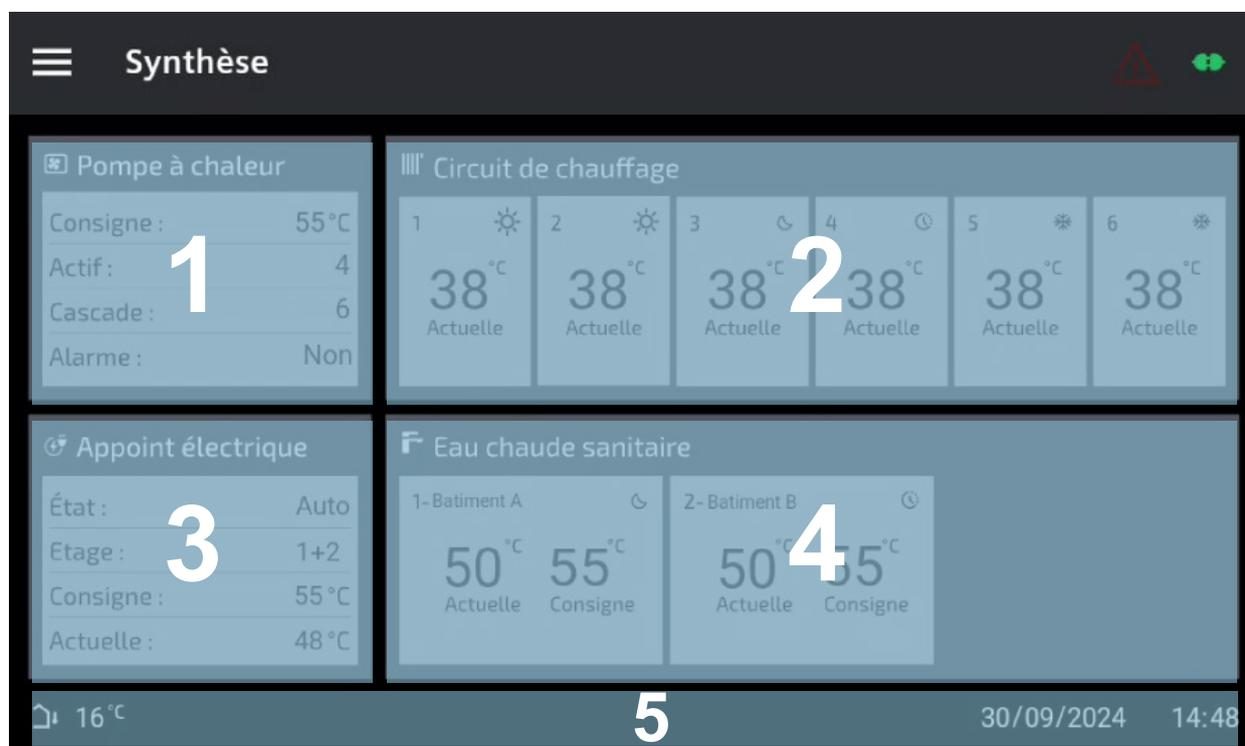
L'affichage de base dépend de l'installation, ainsi que de l'ensemble des éléments actifs de la pompe à chaleur, des circuits de chauffage, d'eau chaude sanitaire et de l'appoint électrique :
