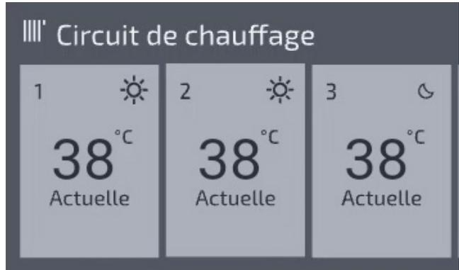
Le bloc -2- du circuit de chauffage montre la température actuelle de chaque circuit actif, le mode et le numéro du circuit
